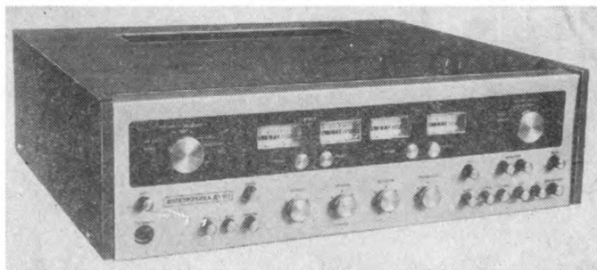
Рис. 42. Внешний вид усилителя низкой частоты комплекса «Электроника Д1-01»
